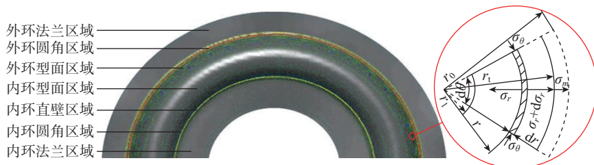
图2 环形曲面预成形件外环圆角区域受力状态
